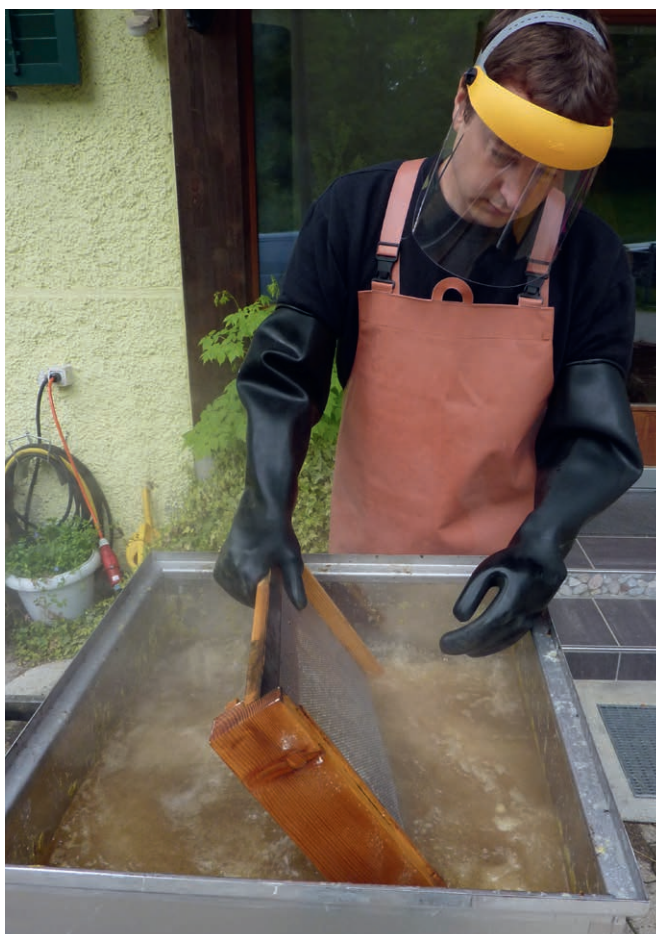
Abb. 7: Natronlauge ist gefährlicher als Soda. Für beide Stoffe ist aber Schutzkleidung ein Muss (Foto: Thomas Amsler).
