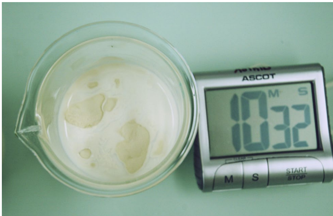
Figure 4 | Campagne de contrôle des produits phytosanitaires 2011. Test de mouillabilité d'un produit phytosanitaire contenant du folpet: après plus de dix minutes, le produit n'est pas encore complètement mouillé.
