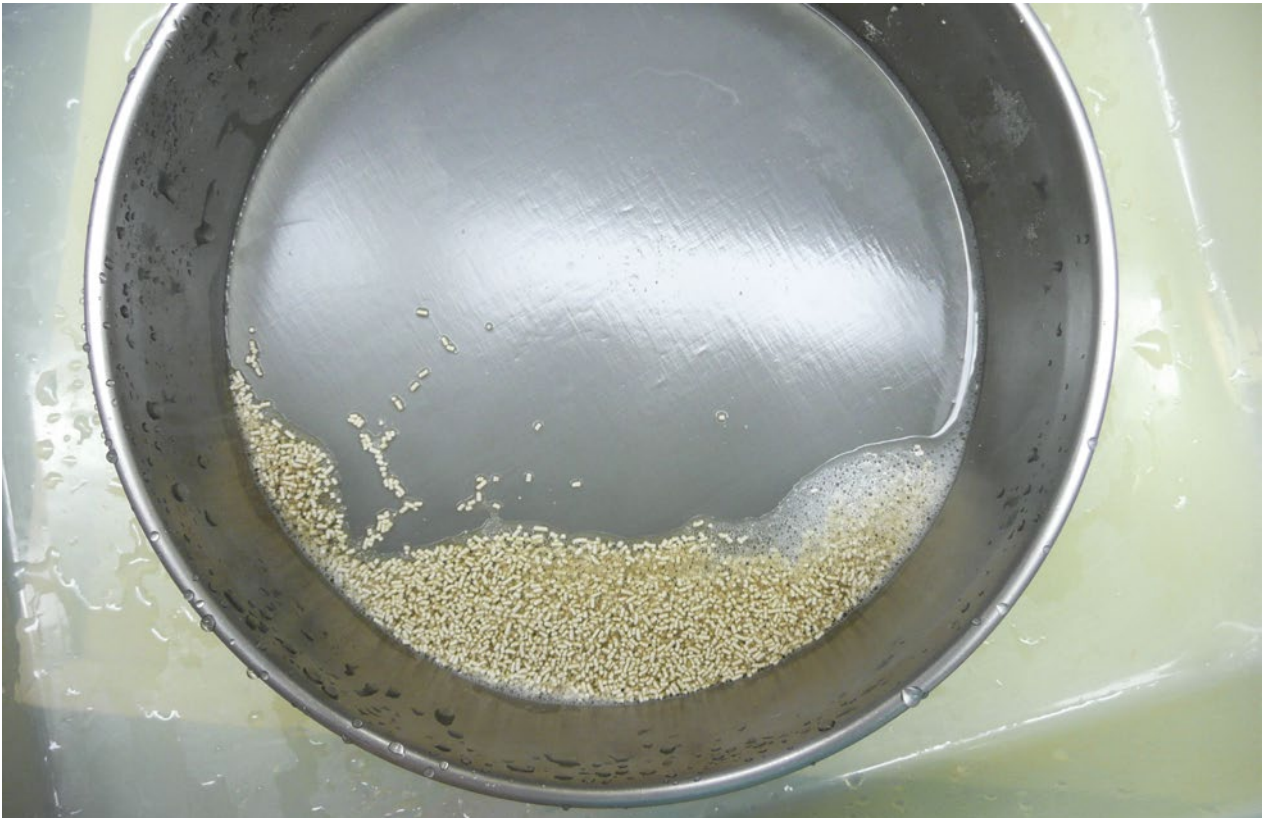
Figure 5 | Campagne de contrôle des produits phytosanitaires 2011. Résidus d'un produit contenant du folpet après le test de tamisage humide.
