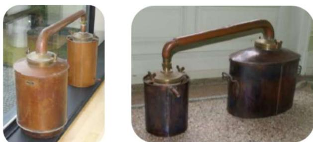
Fig. 1: Alambicchi utilizzati per la distillazione dell'assenzio.
