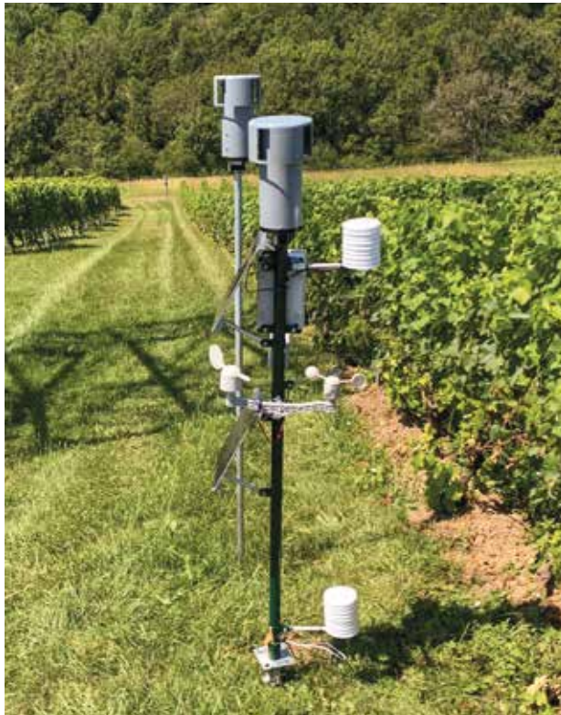
Station de mesure des spores dans l'air installée dans le vignoble de Dardagny (GE). A l'arrière, un impacteur sur filtre.
