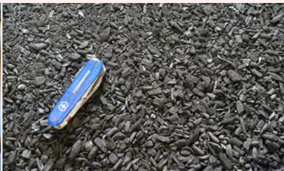
Photo 5.2: Les biochars doivent présenter une granulométrie régulière et de faibles teneurs en polluants ; ces deux aspects sont contrôlés dans le cadre du label « EBC ». Seuls les biochars labellisés sont autorisés par l'OFAG.
