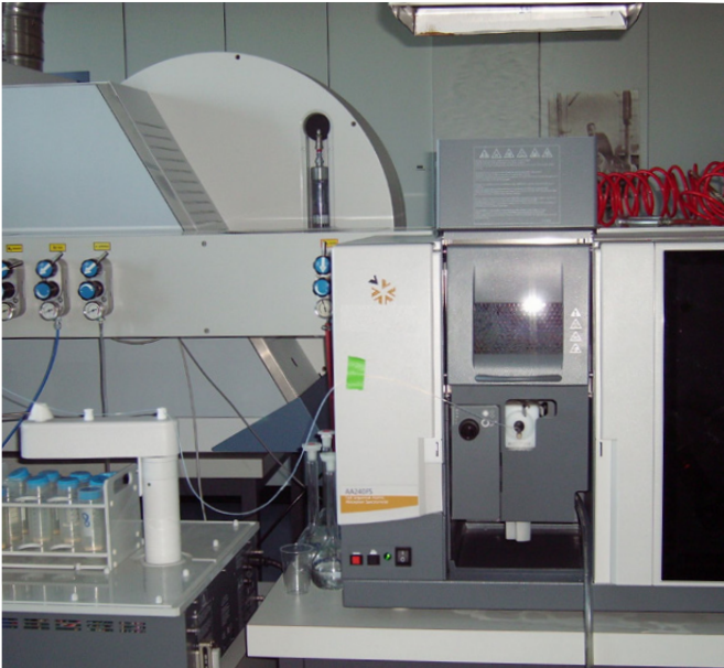
Abbildung 5 | Bestimmung verschiedener Elemente mittels Flammen-Atomabsorptionsspektrometrie AAS (Foto: Diane Bürge, Agroscope).
