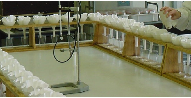
Abbildung 4 | Filtration von Boden-Extrakten (Foto: Diane Bürge, Agroscope).
