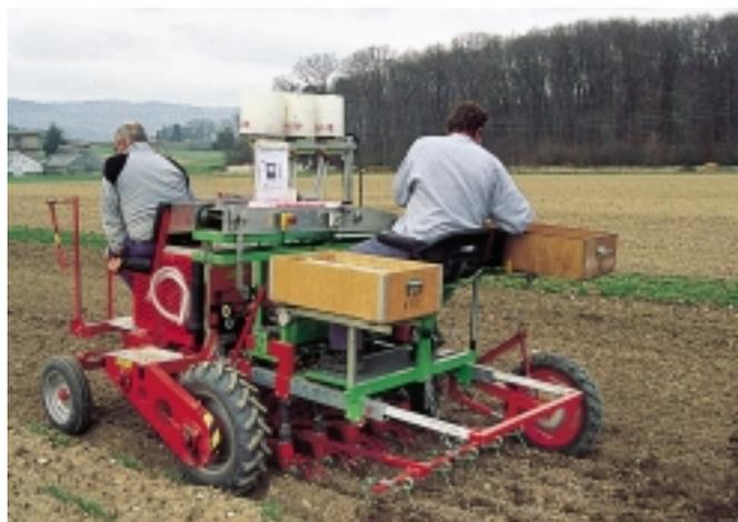
Fig. 9. Un semoir spécialement conçu pour un semis où chaque ligne semée est une autre lignée expérimentale. Il est alors possible de semer sur une surface de 35 m<sup>2</sup> cent lignées différentes.
