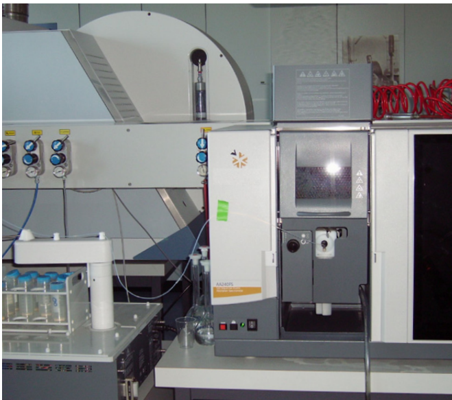
Figura 5. Determinazione di diversi elementi attraverso la spettrometria di assorbimento atomico a fiamma (AAS) (fotografia: Diane Bürge, Agroscope).
