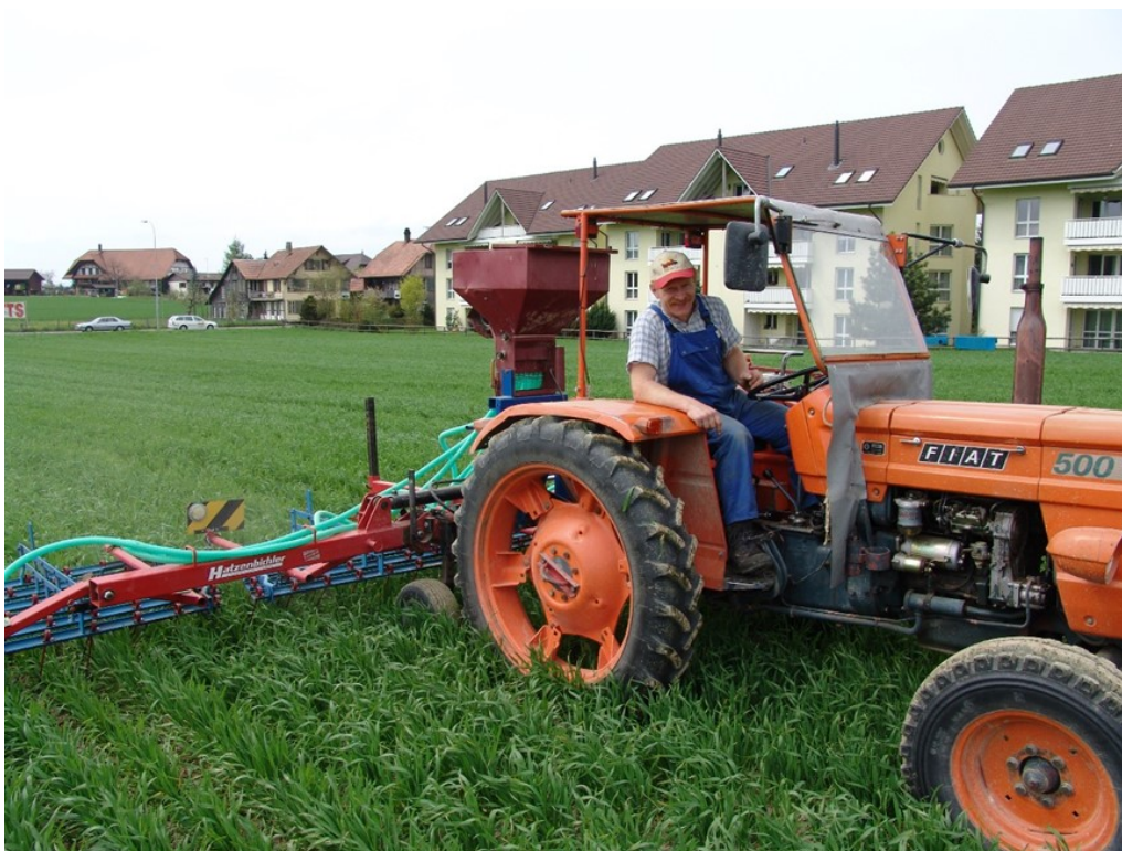
Abbildung 3: Peter Grossenbacher in Hindelbank: Striegel mit Graseinsaat
