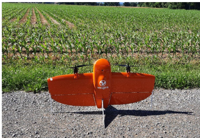
Abb. 1: Die grosse 'wingtra' startet senkrecht. In der Luft beträgt die Mindestgeschwindigkeit 50 km/h und die Flughöhe betrug 60 m (Foto: Agroscope).
