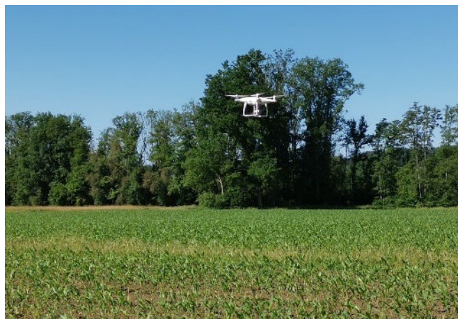
Abb. 2: Die kleinere 'Phantom' kurz nach dem Start. Die Aufnahmen erfolgten in einer Höhe von 10 m (Foto: Agroscope).
