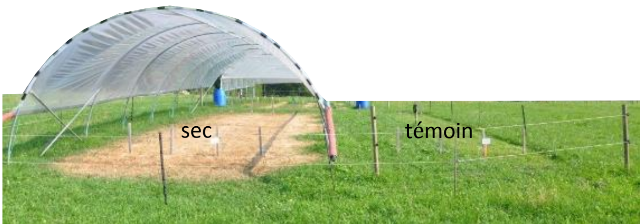
Figure 5. Dispositif de mesure de la croissance de l'herbe des pâturages avec (sec) et sans (témoin) simulation de sécheresse.
