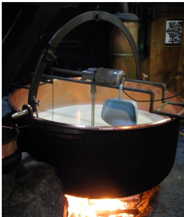
Figure 1: Fabrication dans un chaudron en cuivre avec foyer ouvert
