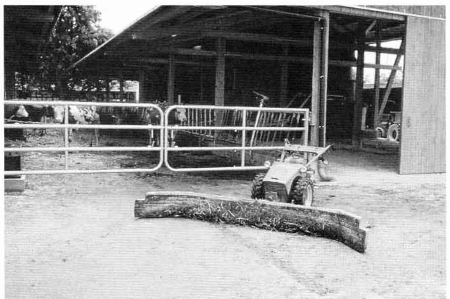
Abb. 6. Motormäher mit Schiebeschild: Durch den ausschliesslichen Einsatz für die Reinigung im Laufhof entfallen Rüstzeiten (Foto BUL).
