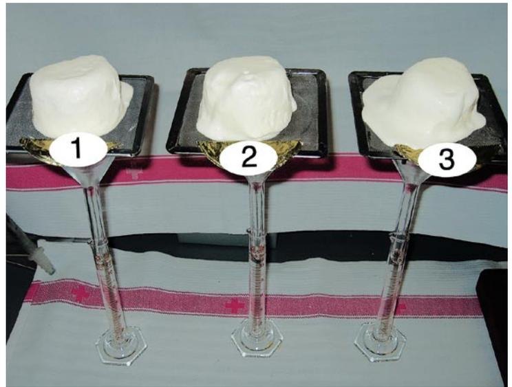
*Au test de pénétration, on calcule la tendreté de la glace en exerçant une force constante.*
