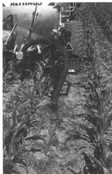
Fig. 9: L'enfouissement du lisier exige un semis précis du maïs et un sol complètement ressuyé. Les dents enfouisseuses demandent une force de traction deux à quatre fois plus élevée.
