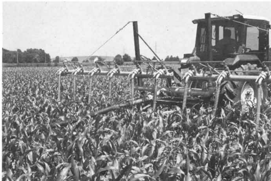
Fig. 3: Le distributeur à tuyaux souples fait couler le lisier directement sur le sol, entre les lignes de maïs, et offre ainsi l'avantage de ne pas salir les feuilles.
