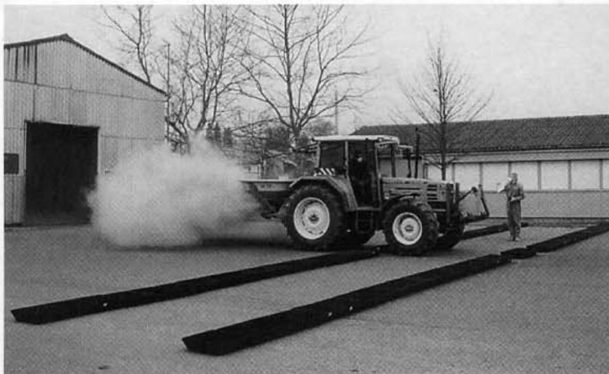
Abb. 1. Versuchsanordnung für die Ermittlung des Streubildes. Das ausgebrachte Material wird in Schalen aufgefangen, und somit kann die Mengenverteilung bestimmt werden. Rechts neben dem Traktor wird gleichzeitig der Staubgehalt in der Luft gemessen.
