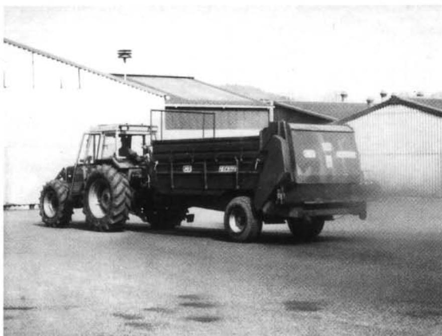
Abb. 5. Der Kompoststreuer ist für das Ausbringen der untersuchten Klärschlammprodukte ungeeignet. Zudem sind mit diesem Gerät die höchsten Staubemissionen zu verzeichnen.
