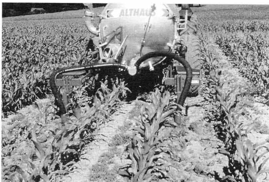
Fig. 11. Systèmes d'enfouissement du lisier dans les cultures de maïs (injection en profondeur): le lisier est injecté dans le sol à 20 cm de profondeur au moyen des dents fixes du cultivateur. Ce système permet pratiquement d'éviter les pertes d'ammoniac.
