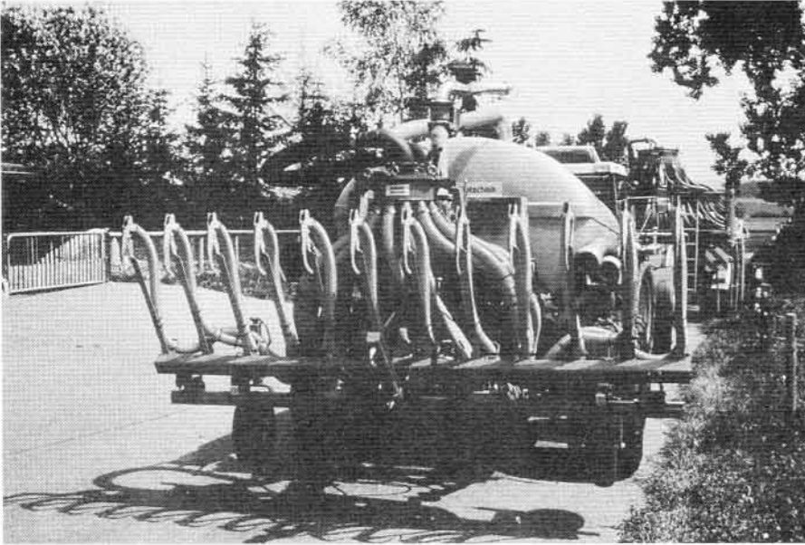
Fig. 9. A l'étranger, les distributeurs à tuyaux semi-rigides avec socs sont considérés comme une solution intéressante pour les cultures fourragères, mais ne présentent pratiquement aucun avantage en Suisse par rapport aux épandeurs à tuyaux souples.
