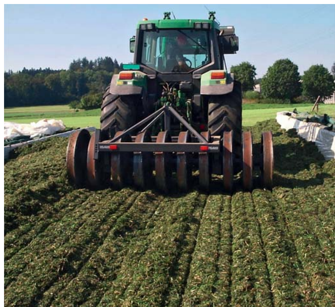
Fig. 7: La compressione accurata del foraggio insilato riduce il rischio di postfermentazioni durante il suo prelievo.
