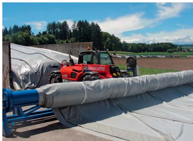
Fig. 14: Dispositivo per lo svolgimento di teli plastici pesanti dotati di tubi per l'acqua che fungono da zavorra.
