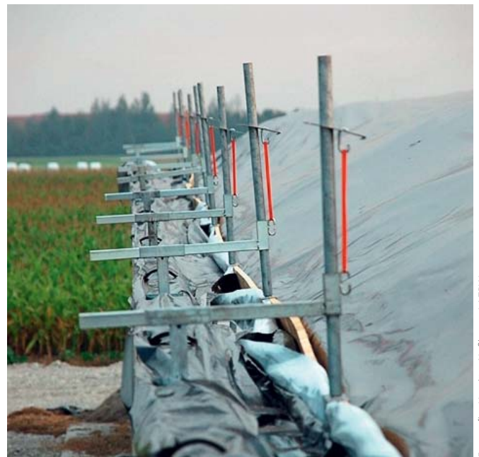
Fig. 12: Esempio di sistema di chiusura con staffe di serraggio a molla; «sistema Duhamel».
