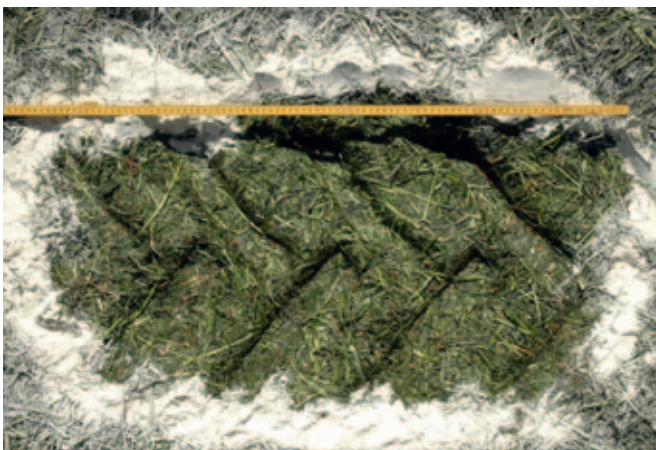
La surface de contact des roues au sol dans le silo a été relevée grâce à un marquage à la chaux et à une détermination photogrammétrique de la surface a posteriori.
