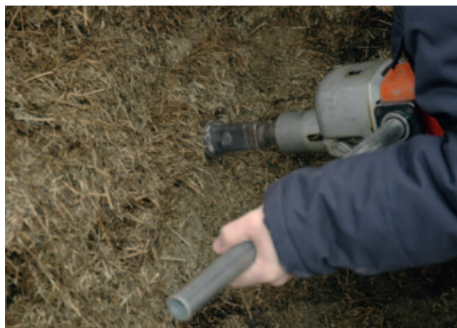
La détermination des compacités grâce à des carottes prélevées par sondage a montré que les densités étaient très hétérogènes dans les silos.
