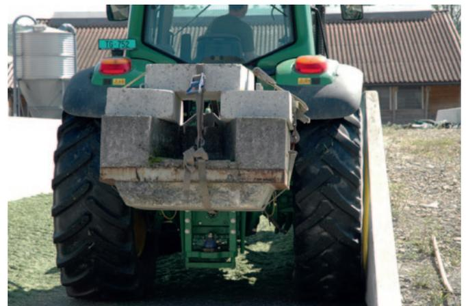
Walztraktor mit unterschiedlich breiter Bereifung.
