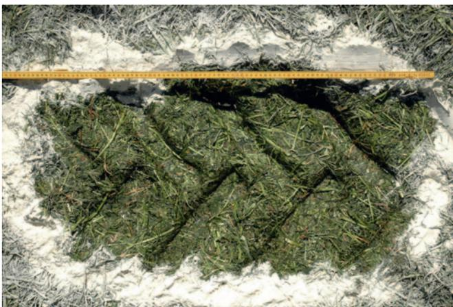
Die Aufstandsfläche der Räder im Silo durch Markieren mit Kalk und anschließender photogrammetrischer Flächenbestimmung erhoben.
