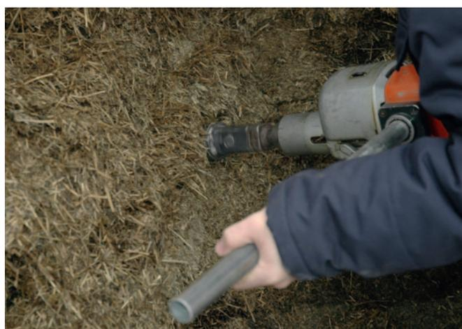
Die Bestimmung der Lagerungsdichten mittels Bohrkernproben zeigte, dass in den Silos die Dichten sehr heterogen sind.
