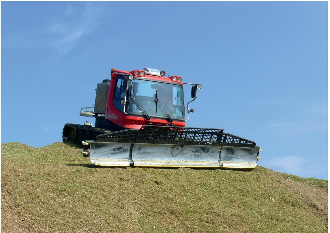
Mittels Pistenfahrzeugen lassen sich Silagen schnell verteilen. Trotz des tiefen Kontaktflächendrucks sind die Erfahrungen in der Praxis sehr gut. Bedingung ist, dass nur flache Schichten festgewalzt werden.
