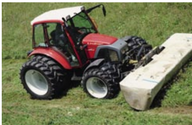
Fig. 8: Pour travailler facilement sur les terrains en pente, les tracteurs doivent être équipés de quatre roues motrices, de roues jumelées et d'un dispositif hydraulique frontal pour la fauche.
