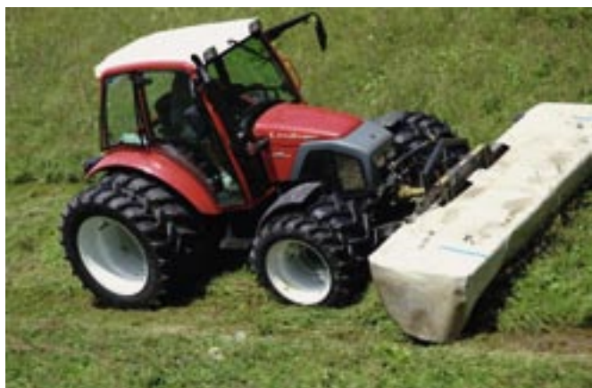
Abb. 8: Für eine hohe Hangtauglichkeit müssen die Traktoren mit Allradantrieb, Doppelbereifung sowie für das Mähen mit einer Fronthydraulik ausgerüstet werden.
