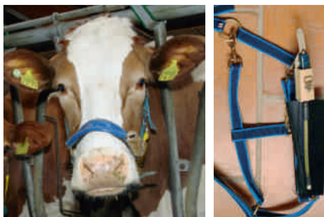
Fig. 1: Le set de mesure se compose d'un capteur de pression et d'un enregistreur de données (MSR145) placés dans une doublure et une poche sur la bride nasale du licol.
