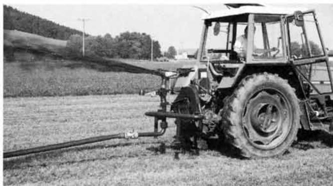
Fig. 3: Répartiteur pivotant entraîné par la prise de force (Meier-Perfekt). Pour les répartiteurs à entraînement par courroie trapézoïdale, la buse pivote horizontalement et verticalement. La fréquence de pivotement est réglée par le régime de la prise de force.
