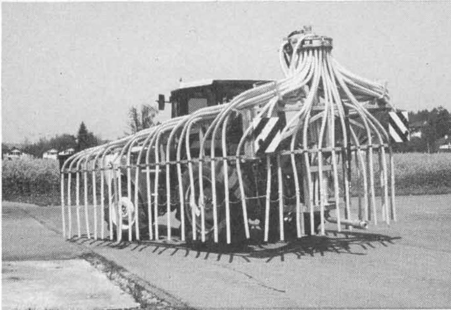
Abb. 15: Da Schleppschlauchverteiler in der Regel überbetrieblich eingesetzt werden, ist eine einwandfreie Signalisierung besonders wichtig. Ein sicherer Transport ist nur mit nach vorne geklappten Auslegern gewährt.
