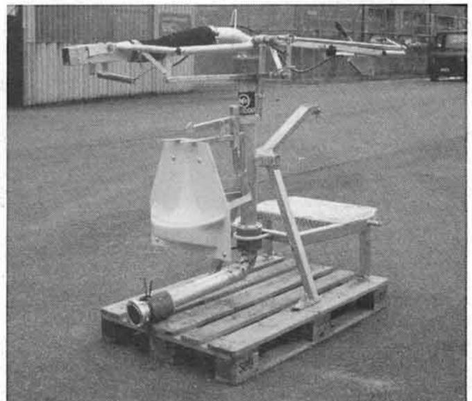
Abb. 2: Kombiverteiler mit Prallteller (Jovo-Kombi B 89): Mit der ausklinkbaren Werferdüse lassen sich Restflächen, die für den Prallteller nicht zugänglich sind, von Hand begüllen. Die Verteilarbeit wird vom Traktorsitz aus oder durch eine zweite Bedienungsperson auf dem Trittbrett vorgenommen.
