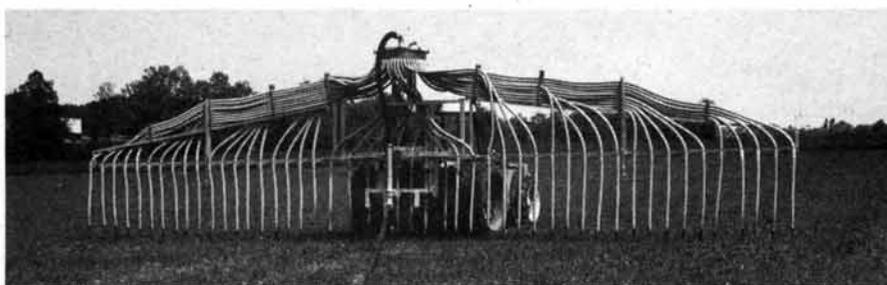
Abb. 5: Schleppschlauchverteiler mit 12 m Arbeitsbreite und 48 Ablaufschläuchen (Vogelsang). Charakteristisch sind die bodennahe Ausbringung und die konstante Arbeitsbreite ohne Überlappungsprobleme.
