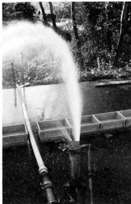
Abb.10: Asymmetrische Verteilung beim Schwenkverteiler: Durch den seitlichen Austritt des Strahls entstehen im Extremfall Abweichungen in der Verteilbreite von bis zu 5 m Unterschied zwischen linker und rechter Seite.
