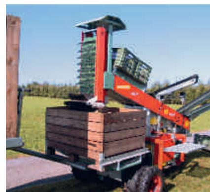
Fig. 17: Le remplisseur de paloxes de la récolteuse Pluk-o-trak permet de répartir régulièrement les pommes dans la paloxe.
