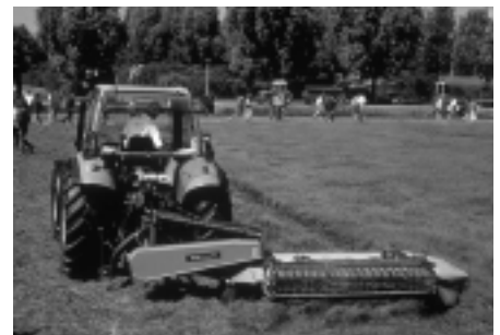
Abb. 2: Optimaler Aufbereitungseffekt bei Intensivaufbereitung (Greenland HPC).
