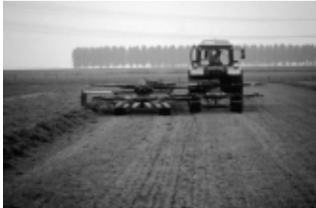
Abb. 21: Im Gegensatz zu herkömmlicher Futterwerbung muss beim Intensivaufbereiter frühzeitig geschwadet werden und das Futter vor dem Einführen noch mindestens eine Stunde am Schwad liegen gelassen werden.
