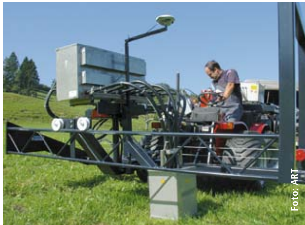
Abb. 3 | Prototyp I mit 4,8 kW Heizleistung.
