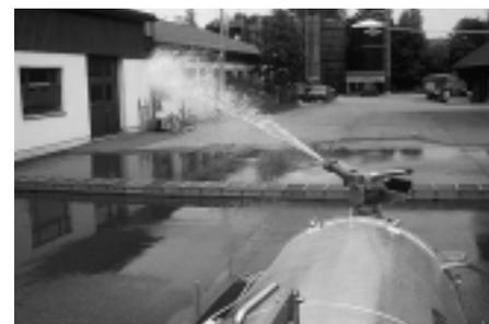
Fig. 14: Le maniement des épandeurs équipés de buses pivotantes n'est pas facile, car la visibilité est mauvaise depuis le siège du conducteur. Cette raison s'ajoute au prix d'achat relativement élevé de l'outil et explique sans doute pourquoi ce système est encore peu répandu sur les citernes.
