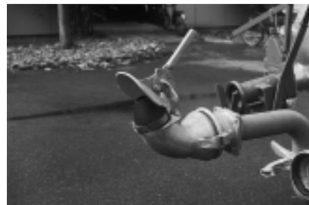
Fig. 2: Déflecteur avec alimentation de la tôle déflectrice par le haut (photo de gauche) et par le bas (photo de droite).
