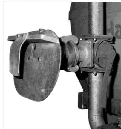
**Modèle: Vakuumat    Type: Répartiteur à tête déflectrice**
