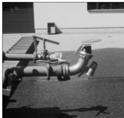
**Modèle: Armatec-Streicher      Type: Répartiteur à jet plat**
