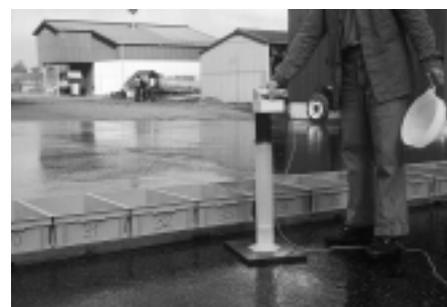
Fig. 4: Banc d'essai pour mesurer la répartition transversale (photo de gauche); évaluation volumétrique des quantités avec le capteur à ultrasons (photo de droite).
