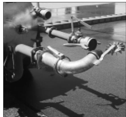
**Modèle: Armatec-Streicher    Type: Répartiteur pendulaire FTS**
