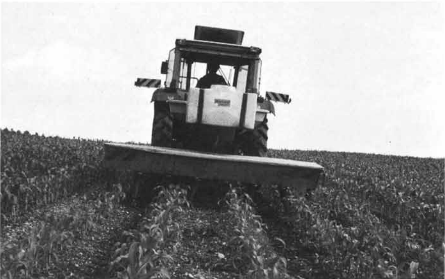
Fig. 6. Sur les terrains en pente, la précision d'épandage des systèmes avec caisson de distribution diminue fortement (distributeur en ligne Vicon).
