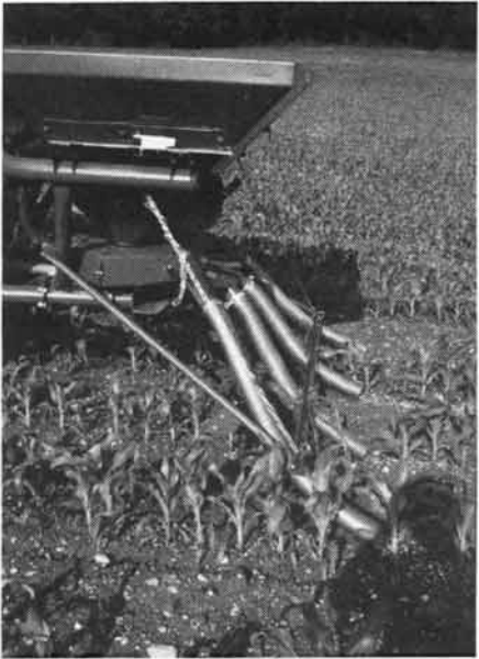
Fig. 9. Les tuyaux flexibles offrent l'avantage de ne pas blesser les plantes. Si le diamètre est suffisamment grand, l'engrais ne risque pas de se bloquer à l'intérieur des tuyaux (distributeur en ligne Amazon).
