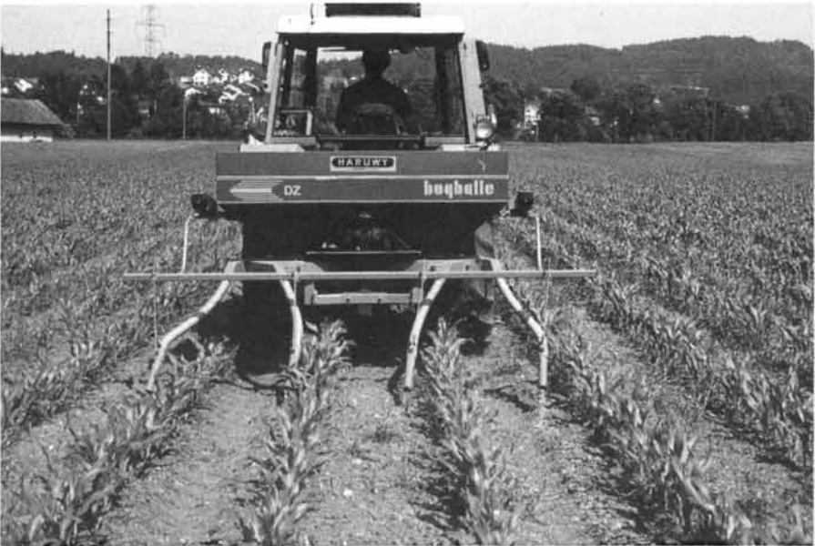
Fig. 8. Les performances réalisables par l'épandage en ligne sont plutôt modestes. Cet inconvénient ne peut pas entièrement être compensé par une vitesse d'avancement plus élevée. La répartition de l'engrais sur les lignes est d'autant moins précise que la vitesse d'avancement est élevée (distributeur en ligne Bögballe).
