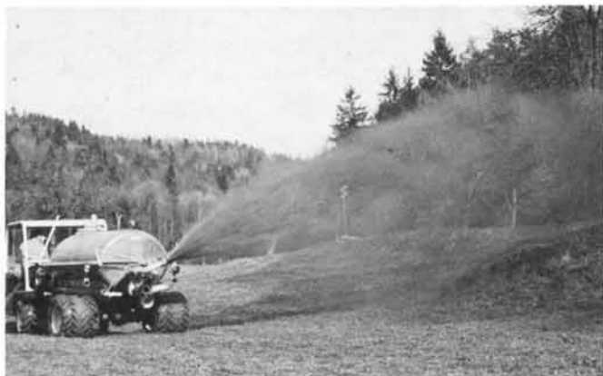
Fig. 4. Dans la mesure où la puissance d'éjection est suffisante, on peut aussi épandre le lisier sur les terrains non praticables avec une citerne à pompe équipée d'une buse de projection. L'avantage des citernes en matière plastique, c'est que l'on peut toujours voir combien il reste de lisier à l'intérieur.
