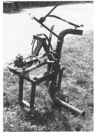
Fig. 11. Les répartiteurs pivotants – ici avec commande hydraulique – permettent des largeurs de travail jusqu'à 25 m. Dans les grandes cultures, ils sont préférables aux déflecteurs, car le déplacement des outils doit être changé moins souvent.
