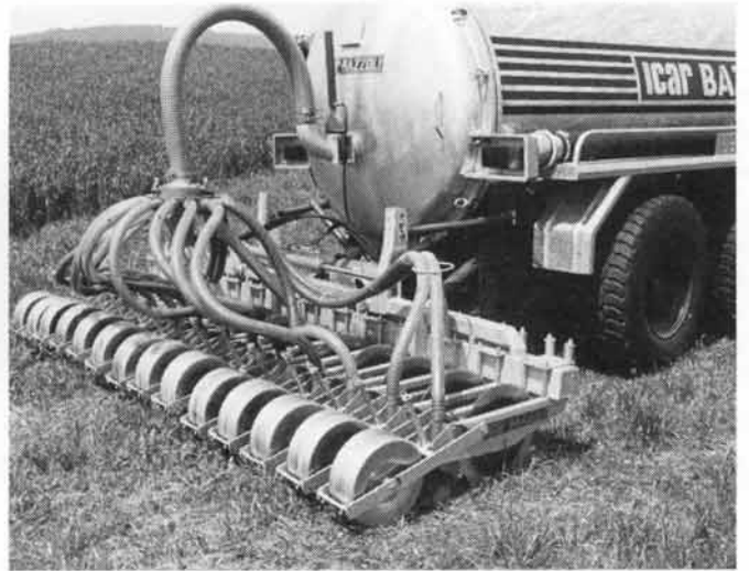
Fig. 18. Le développement de nouveaux procédés et de nouveaux appareils essaye de tenir compte des exigences croissantes en matière d'épandage du lisier. L'avenir dira si les techniques onéreuses, beaucoup préconisées à l'étranger, telle que l'enfouissement du lisier dans les prairies (photo de droite), répondent aux conditions suisses et se justifient de ce point de vue.
