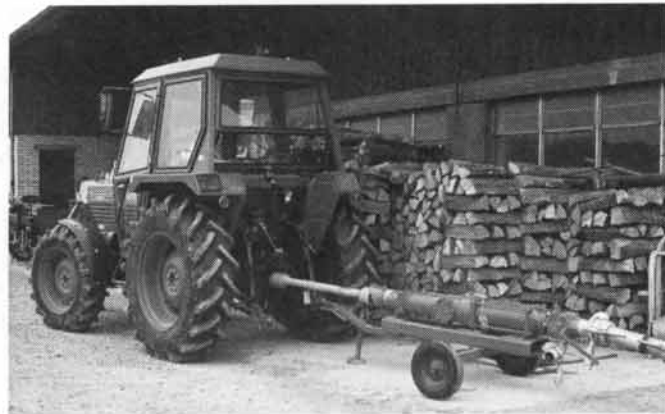
Fig. 7. Pour le purinage par tuyau, les pompes à vis sont aujourd'hui les plus utilisées. Pour garantir une puissance suffisante, elles sont souvent entraînées par la prise de force du tracteur. Pour éviter les dégâts que pourrait causer une obstruction de la conduite, les pompes devraient être équipées du côté refoulement d'une sécurité en cas de surpression.
