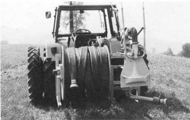
Fig. 10. Les enrouleurs combinés (enrouleur avec distributeur automatique) présentent un avantage: l'enrouleur n'a pas besoin d'être dételé une fois les tuyaux sont déroulés. Pour les surfaces difficilement accessibles, le déflecteur peut être branché sur commande manuelle depuis la cabine du tracteur.
