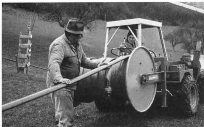
Fig. 8. Les tuyaux souples peuvent être enroulés sur un petit treuil, ce qui économise de la place. Contrairement aux conduites PE, il ne faut pas les tirer lorsqu'ils sont vides, car sinon ils se tordent.
