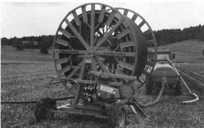
Fig. 14. Epandage du lisier au moyen de l'arroseur automatique: Le moteur à essence intégré garantit une exploitation sans problème, indépendamment du flux de lisier et un avancement suffisamment rapide de l'arroseur.
