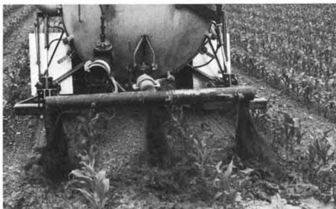
Fig. 6. Fonctionnel et encore bon marché: épandeur en ligne pour l'épandage tardif du lisier dans les cultures de maïs. Comme on ne peut fumer que trois rangées intermédiaires, un nombre élevé de passages se produit.
