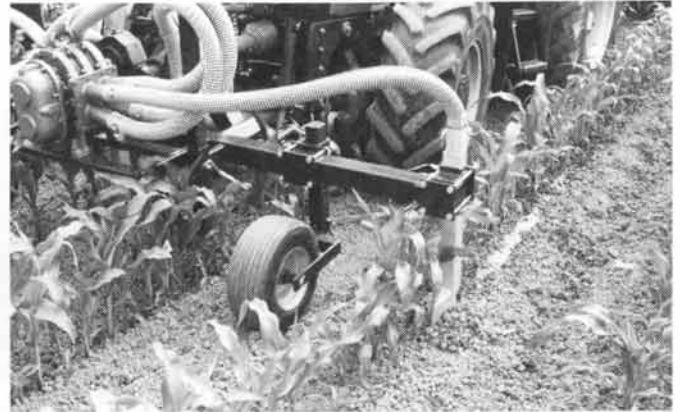
Fig. 13. Epandeur enfouisseur en lignes (5 lignes) en montage frontal: la pompe intégrée répartit le lisier depuis la citerne sur les différents injecteurs. L'enfouissement direct permet d'éviter pratiquement toutes les pertes d'azote sous forme gazeuse.
