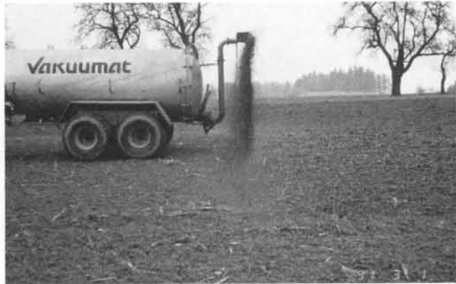
Fig. 5. Citerne à pression avec déflecteur: le fait de pouvoir baisser ou monter le déflecteur permet d'adapter la largeur de travail suivant la nécessité, dans un secteur variant entre 10 et 14 m. Ce type de distributeur est tout à fait approprié à l'épandage du lisier dans les grandes cultures dans lesquelles on a laissé des passages.
