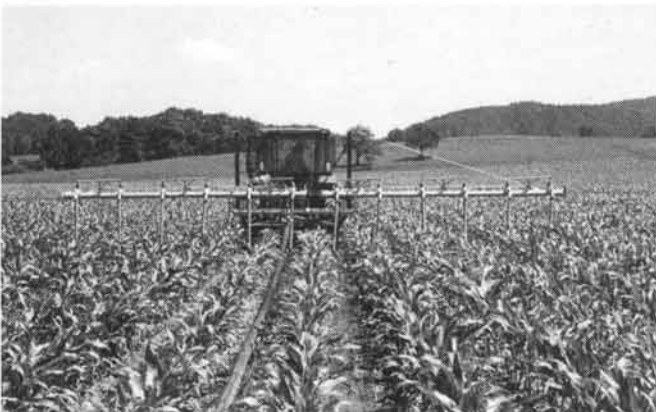
Fig. 12. Les rampes d'épandage à tuyaux souples sont particulièrement avantageuses dans les grandes cultures: haute précision dans la répartition, pas de végétation souillée, moins de pertes d'ammoniac. Elles doivent cependant pouvoir être utilisées suffisamment.
