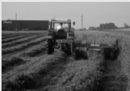
Abb. 13: Der erfolgreiche Einsatz des Schwadwenders beginnt schon beim Mähen. Gefragt sind Mähwerke mit Aufbereiter und mit sauberer Schwadformung. Die Stoppelhöhe darf nicht unter 6 cm liegen. Es ist vorteilhaft, den Bestand schon am Vorabend zu mähen, damit der Boden zwischen dem Mähgut bis zum Mittag vollständig abtrocknen kann.
