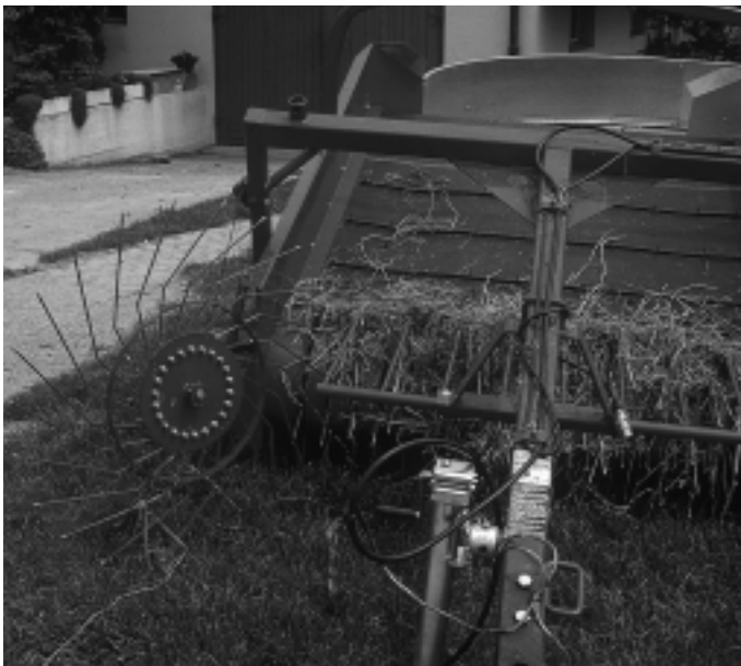
Abb. 9: Das vor dem Pick-up angebrachte Sternrad verhindert grössere Aufnahmeverluste, wenn Schwade mit einer Breite von über 120 cm geformt werden.
