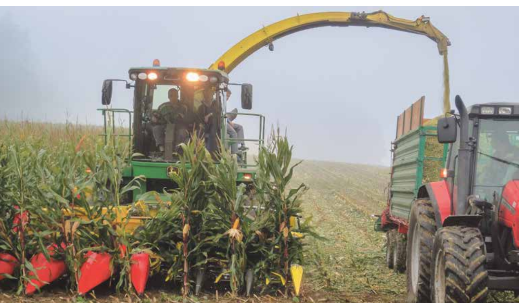
Figure 1 | Ensileuse automotrice équipée pour la récolte de 3 rangs en plantes entières et 3 rangs d'épis. (Photo: Jean-Luc Oberson, Agroscope)
