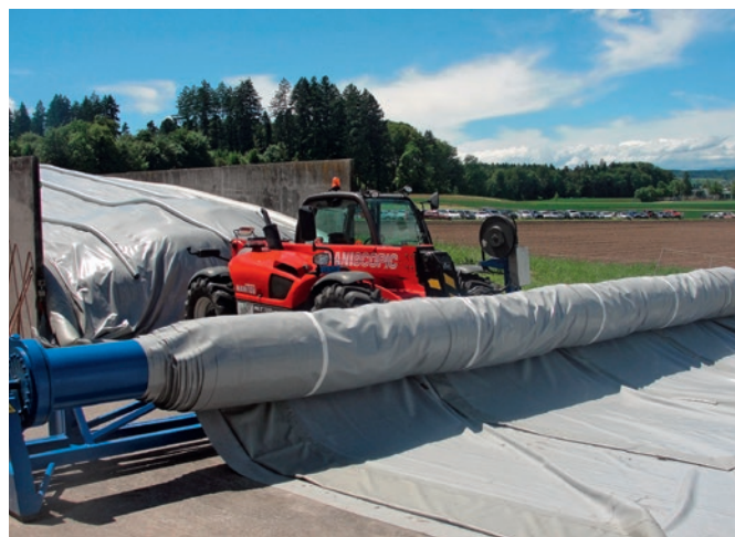
Fig. 14: Dispositif de déroulement des lourdes bâches de silo avec tuyaux à eau intégrés pour lester.
