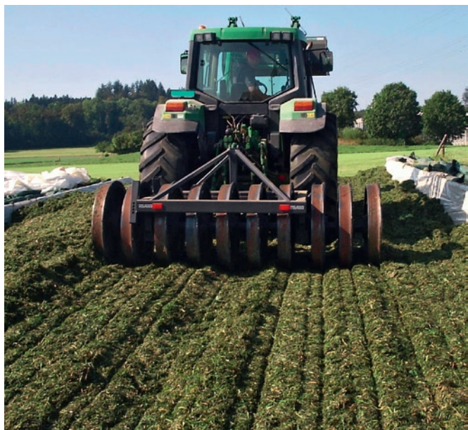
Fig. 7: Un bon compactage réduit le risque de post-fermentations lors de la reprise ultérieure du fourrage.
