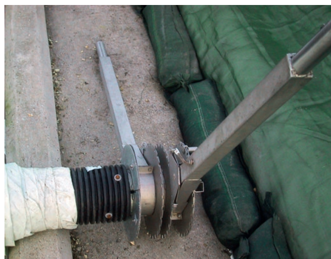
Fig. 13: Mécanisme de cliquet pour dérouler et tendre efficacement la bâche du silo.
