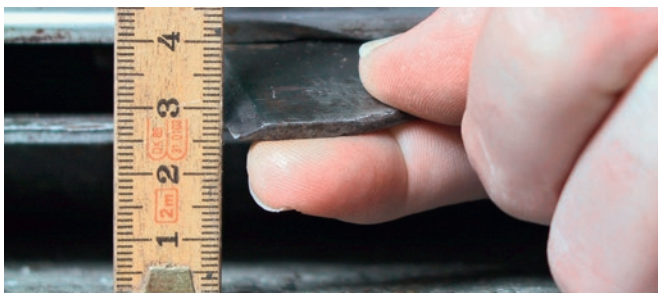
Fig. 5: Pour des chaumes de 6–7 cm de hauteur, il faut une distance d'environ 3 cm entre la lame et le sol.
