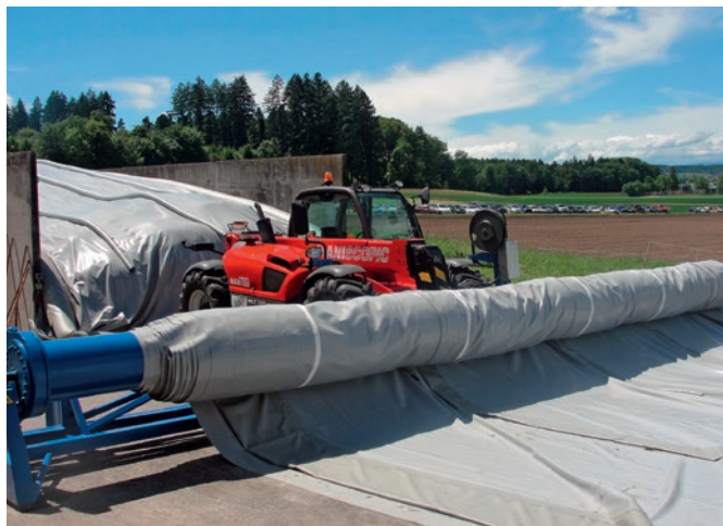
Abb. 14: Abrollvorrichtung für schwere Silofolien mit integrierten Wasserschläuchen zur Beschwerung.
