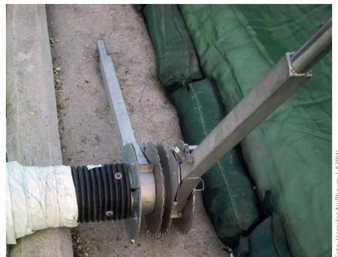
Abb. 13: Ratschenmechanismus zum effektiven Ab- und Aufrollen der Silofolie.
