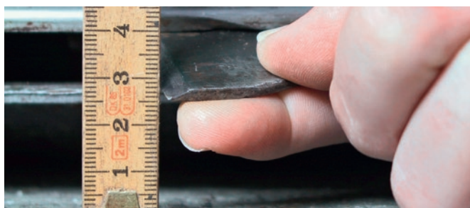
Abb. 5: Eine Stoppelhöhe von 6–7 cm bedingt einen Klingenabstand zum Boden von rund 3 cm.
