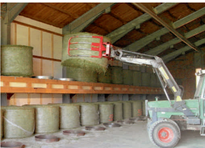
Abb. 6: Beschickung einer zweireihigen Anlage mit Bodenkanal und darüberliegender dritter Ballenreihe mit Frontlader und Wendezange.
