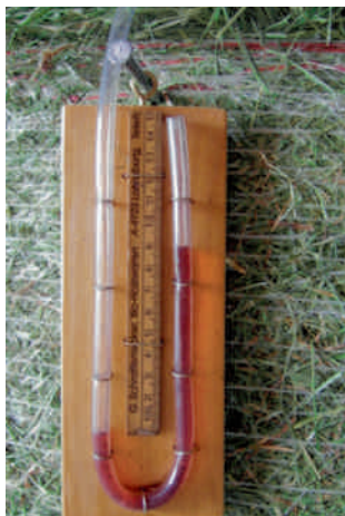
Abb. 20: Druckmessung mit einem PVC-Schlauch. Ein Schlauchende reicht in den Ballenkanal, die Höhendifferenz der Wasserspiegel zeigt den Druck in mm Wassersäule (1 mm WS = ca. 10 Pa).
