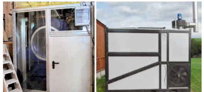
Abb. 18: Links Kompaktanlage mit Entfeuchter; rechts Warmluftöfen.
