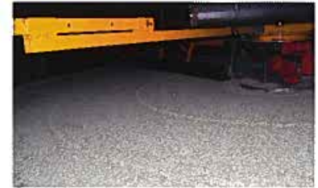
Abb. 4. Entnahme mit einer Silofräse (Foto: GB Silo System AG)
