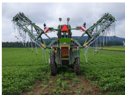
Foto 10: Dropleg su una barra di 21 m Amazone in una coltura di fagiolini nano. a) apertura idraulica della barra. b) I dropleg passano nella coltura a ca. 15 cm dal suolo con una distanza fra le file di 50 cm a una velocità di ca. 5 km/h e 250 l/ha volume di poltiglia (pressione: 2.5-3 bar). c) Gli ugelli ad angolo ampio con un angolo di ca. 95° sono posizionati orizzontalmente, in modo che le piante siano irrorate lateralmente e parallelamente al livello del suolo.
