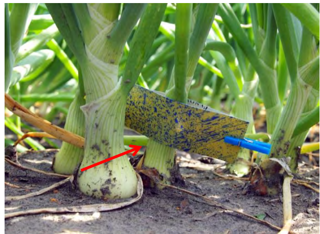
Foto 15: Dropleg montate su una barra di trattamento automotrice di 28 m in una coltura di cipolle. Il semplice controllo della distribuzione della poltiglia con cartine idrosensibili, ha evidenziato come il solo uso dei dropleg permetta una sua omogenea ripartizione su tutta la coltura, sia a uno stadio precoce (23 giugno), sia ad uno più tardivo (14 luglio). Malgrado una forte pressione da peronospora, l'infezione ha potuto essere combattuta con successo. Negli ultimi anni questo risultato non è stato raggiunto in modo soddisfacente con l'uso di barre di trattamento equipaggiate in maniera tradizionale.
