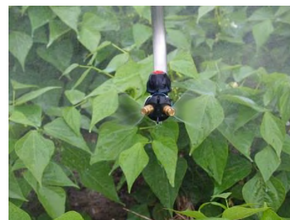
Foto 10: Dropleg su una barra di 21 m Amazone in una coltura di fagiolini nano. a) apertura idraulica della barra. b) I dropleg passano nella coltura a ca. 15 cm dal suolo con una distanza fra le file di 50 cm a una velocità di ca. 5 km/h e 250 l/ha volume di poltiglia (pressione: 2.5-3 bar). c) Gli ugelli ad angolo ampio con un angolo di ca. 95° sono posizionati orizzontalmente, in modo che le piante siano irrorate lateralmente e parallelamente al livello del suolo.
