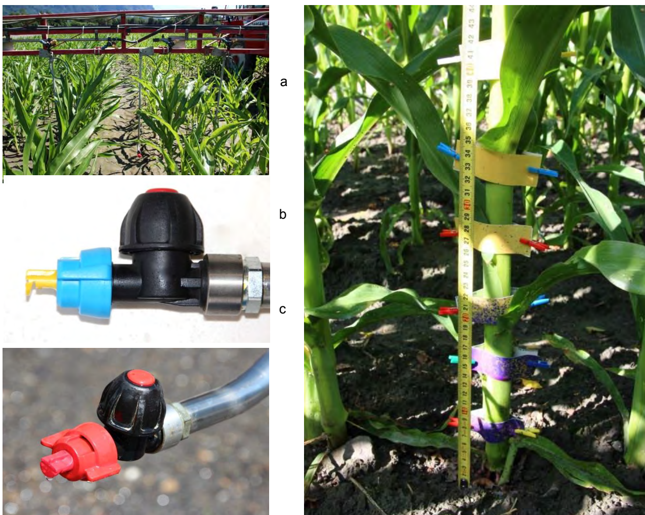
Foto 24: impiego di dropleg in una coltura di mais a uno stadio di sviluppo avanzato (a). Solo le parti più in basso degli steli sono raggiunti: il fogliame resta pressoché totalmente a riparo dall'aspersione (foto destra). Il dropleg è equipaggiato con un ugello diretto verso il basso con un angolo d'aspersione di 140° (b, c). La larghezza della banda d'aspersione è regolata con l'altezza dell'ugello (altezza della barra di trattamento).
