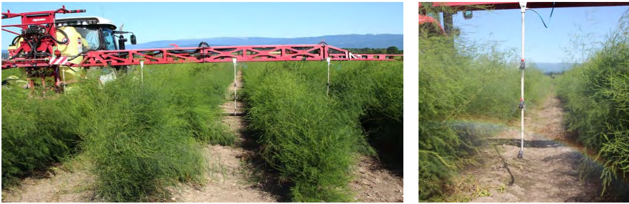
Abb. 22: Droplegs im versuchsmässigen Einsatz in Spargeln am 18. Juli 2012: 120 cm lang, mit 3 Paaren von Zungendüsen Kaliber 05; Reihenabstand 1.8 m. Brühvolumen rund 1000 l/ha bei 5 bar Druck und 5 km/h Fahrgeschwindigkeit.
