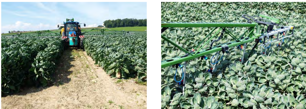
Abb. 12: Droplegs mit je zwei Zungendüsen unten und in der Mitte des zentralen Kunststoffrohres (vgl. auch Abb. 6b) eignen sich gut für hochwachsende Kulturen wie zum Beispiel Rosenkohl (vgl. auch Abb. 1). Im Jugendstadium der Kultur werden die oberen Düsen an den Droplegs geschlossen. Da sich die Düsen der Droplegs im Innern des Bestandes befinden, wird eine unerwünschte Abdrift weitgehend vermieden.
