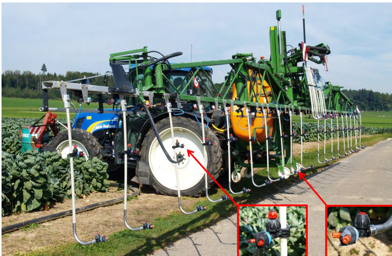
Abb. 1: Eine verlängerte Version von Droplegs mit je zwei Paaren von Zungendüsen auf zwei Höhen für die Applikation von Fungiziden und Insektiziden in Rosenkohl. Die Düsen oben am Balken werden ausgeschaltet.
