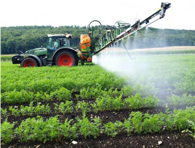
Abb. 2: Standardspritztechnik mit Flachstrahldüsen, welche von oben nach unten in den Pflanzenbestand (Karotten) sprühen.
