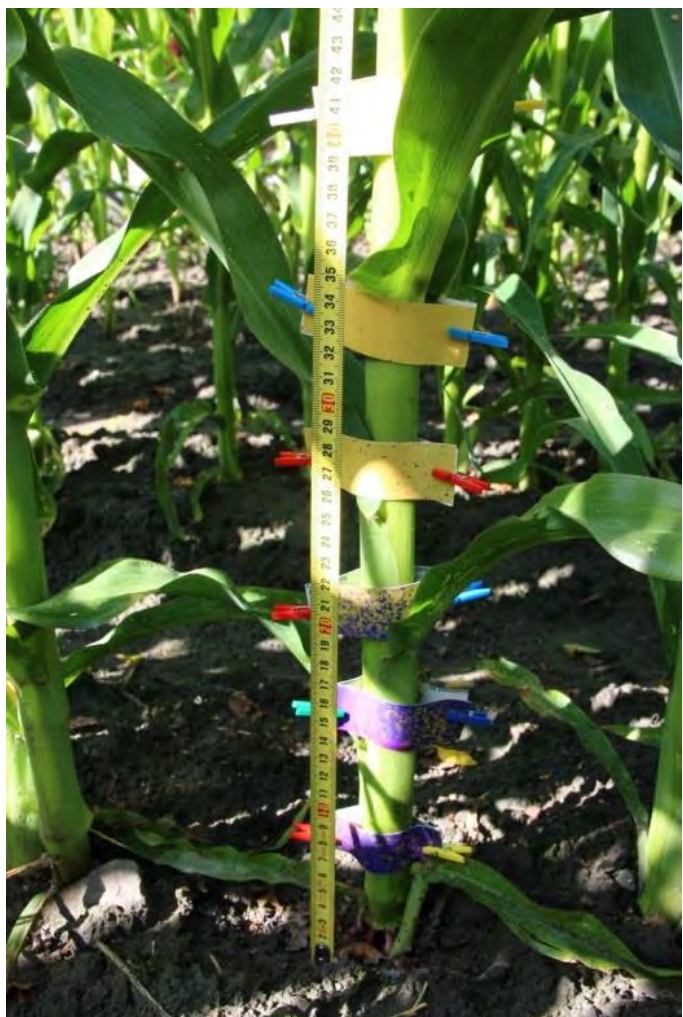
Abb. 24: Einsatz von Droplegs in einem fortgeschrittenen Entwicklungsstadium des Maises (a). Es werden nur die untersten Abschnitte der Maisstängel besprüht; das Blattwerk bleibt praktisch vollständig unbesprüht (Bild rechts). Am Dropleg wird eine Zungendüse mit einem Spritzwinkel von 140° nach unten gegen den Boden gerichtet eingesetzt. (b, c). Mit der gewählten Höhe der Düse über dem Boden (Balkenhöhe) wird die gewünschte Bandbreite der Spritzung eingestellt.
