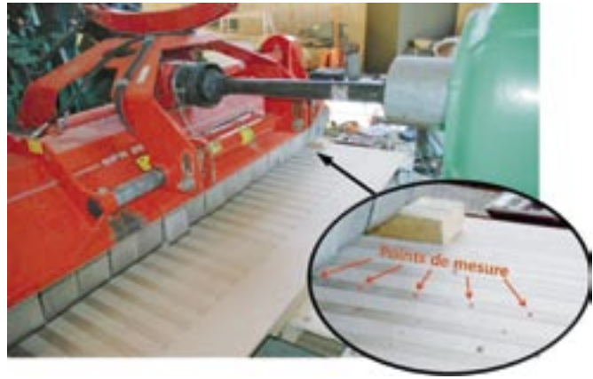
Fig. 7: Dispositif de mesure: des lices interchangeable avec un total de sept points de mesure, placées sous et derrière le rotor, permettent d'enregistrer individuellement les conditions de pression sous chaque fléau (photo: Roy Latsch, ART).
