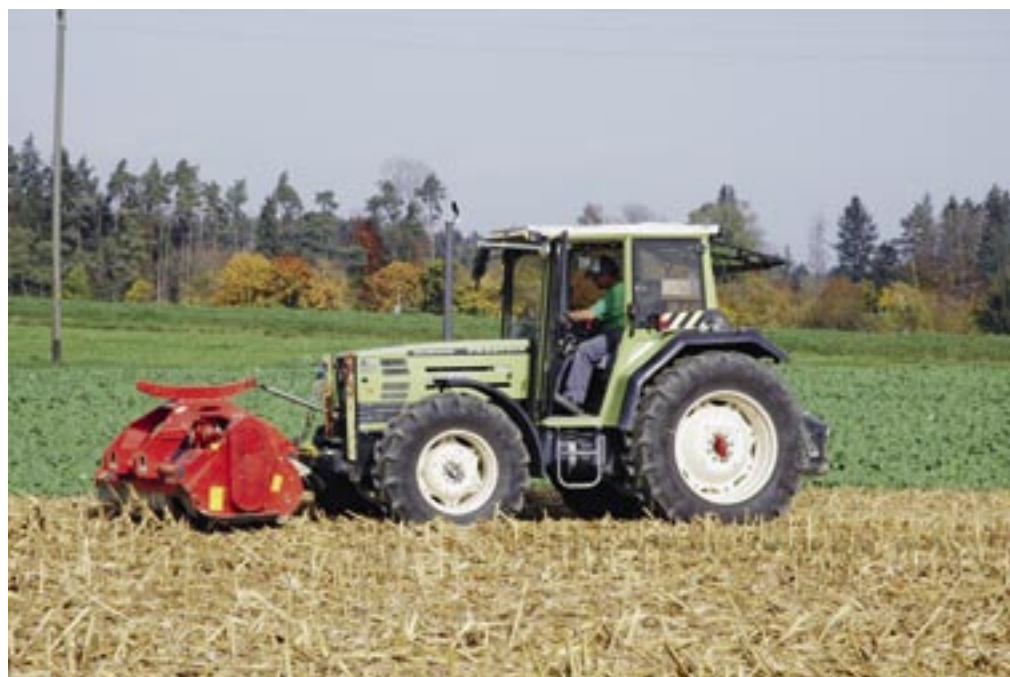
Broyeurs de paille de maïs avec différents fléaux – Essai avec le broyeur Kuhn BPR 280 (photo: Joachim Sauter, ART).
