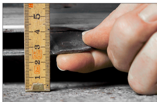
Eine Stoppelhöhe von 6 bis 7 cm bedingt einen Klingenschnitt zum Boden von rund 3 cm.
