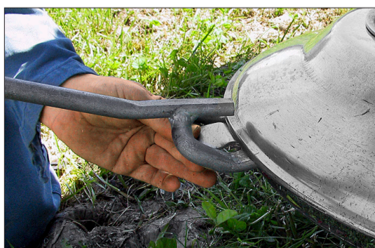
Die meisten Trommelmäher sind mit Schnellspannsystemen ausgestattet.
