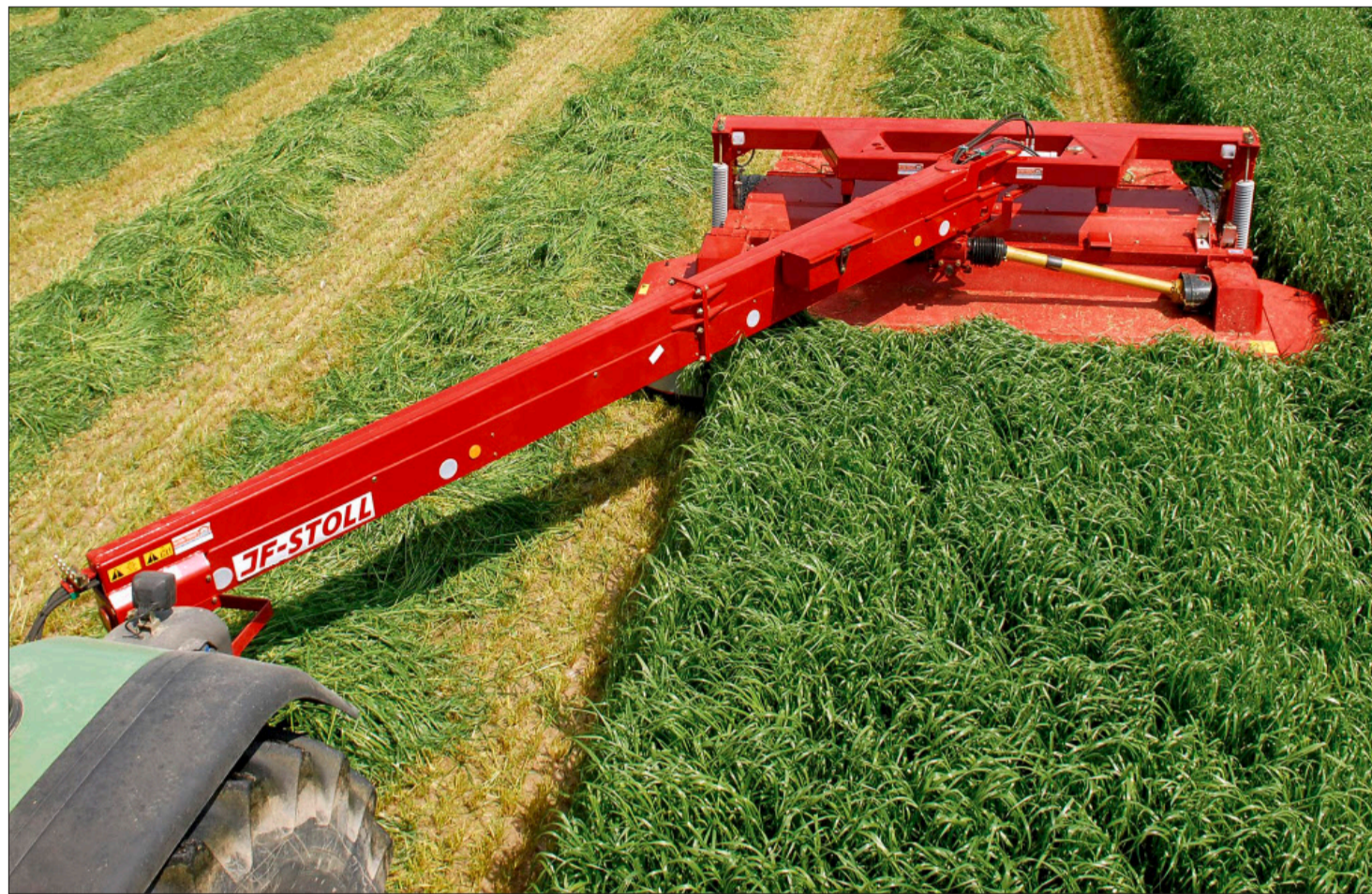
Aufgesattelte Mähwerke mit mittlerer Deichsel können zu beiden Seiten ausgeschwenkt werden. (Bild: zvg)
