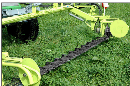
Schützt die Fauna: Messerbalken werden zunehmend auf Ausgleichsflächen eingesetzt.
