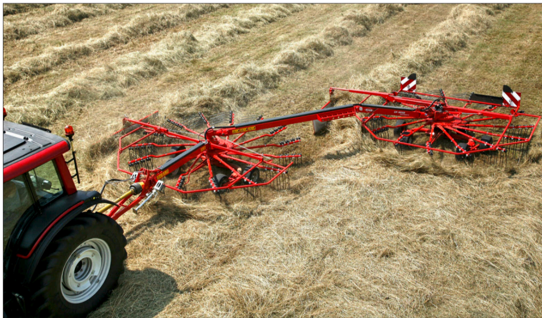
Mit diesem Seitenschwader können je nach Bedarf Einzel-, Doppel- oder Vierfachschwade gebildet werden. (Bild: zvg)
