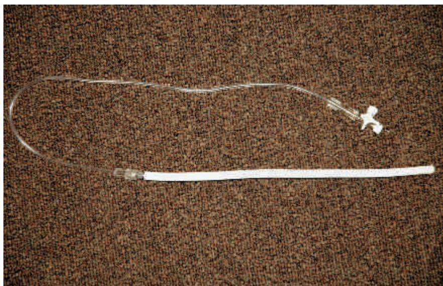
Abb. 2: Messung des Sauerstoffgehaltes in der Bodenluft mittels gasdurchlässiger «Gore-Tex»-Schläuche (unten) und mobilem Gasmessgerät (oben).
