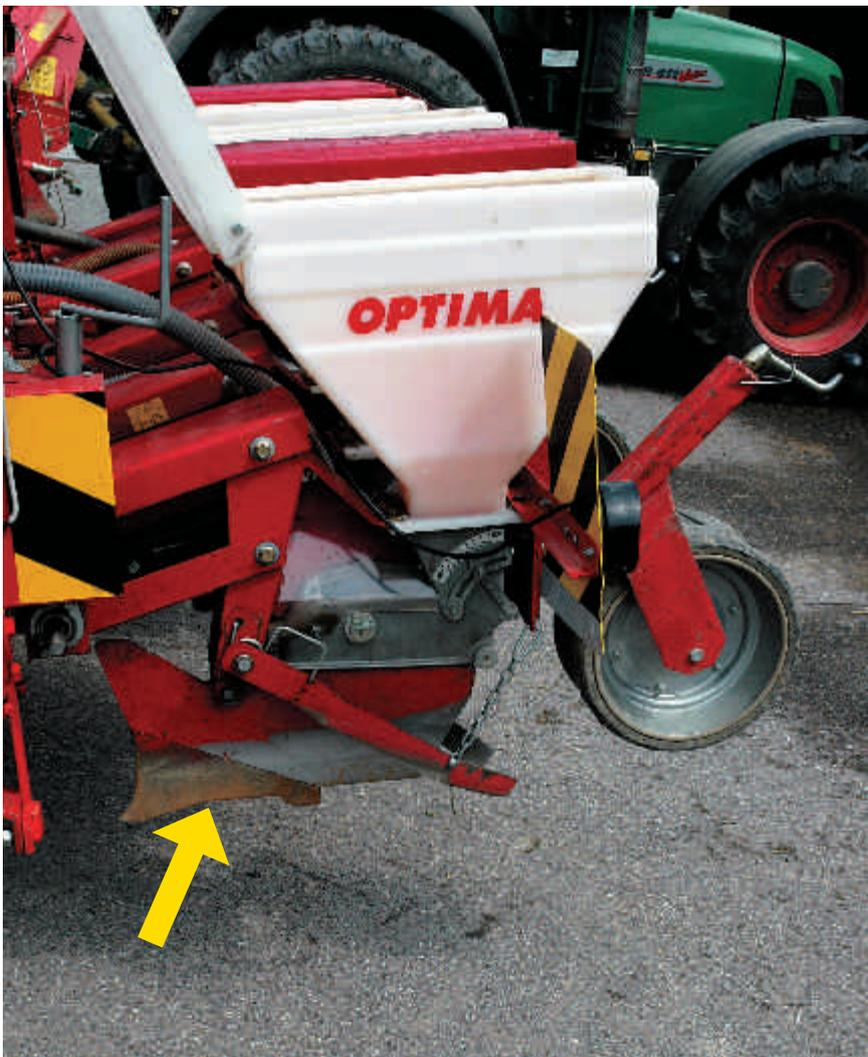
Abb. 9: Scheibenscharen (oben) besitzen den Hauptvorteil, dass sie im Vergleich zu Meisselscharen (unten) nicht verstopfen. Wird jedoch zu hoher Anpressdruck auf die Scheiben angewendet, kann sich der Säschlitz stark verdichten. Vorteil der Meisselschar ist, dass sie den Schlitz aufreiss und ihn nicht mit hohem Gewicht wieder zugpresst.
