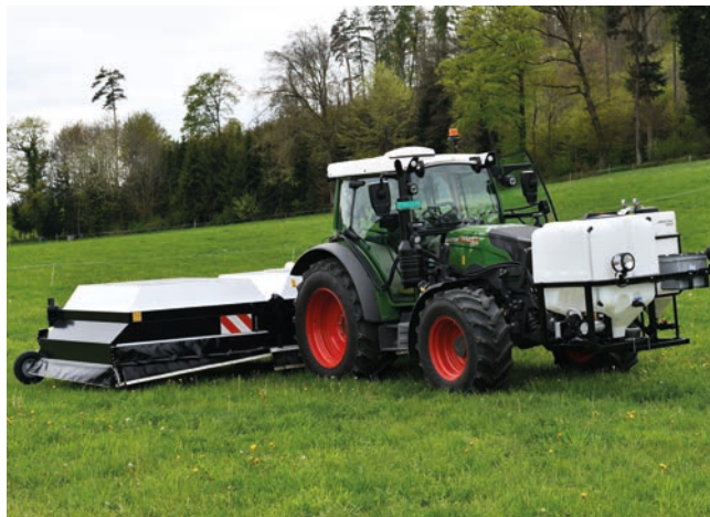
Ecorobotix erkennt Blacken automatisch und behandelt diese einzelstockweise.
