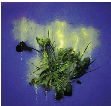
Ecorobotix wie die Rückenspritze besprühen mehr als nur die Blackenblätter. Spritzbrühe ist gelb sichtbar.
