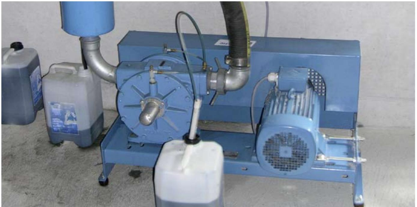
Montage der Vakuumpumpe auf an das Pumpengewicht angepasste Gummiunterlagen sowie elastische Verbindung zum Auspuff und zur Hauptleitung verhindern die Übertragung der Vibrationen. (FAT-Bericht 625)
