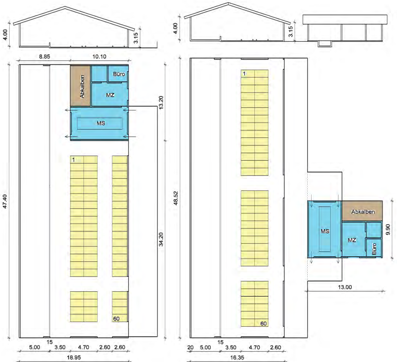
Abb. 1: Liegeboxenstall für 60 Milchkühe mit integriertem (links) und losgelöstem Melkstand (rechts).
