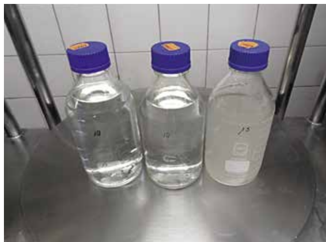
Abb. 8: Wasserproben ab Schlauch. Von links nach rechts: Probe ab Hahn, Probe ab Schlauch, Probe ab Schlauch nach leichtem Bürsten der Schlauchinnenseite. Man beachte die Trübung des Wassers in der Probe rechts.
