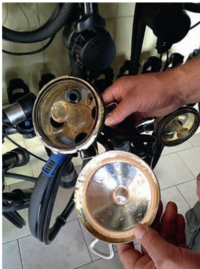
Abb. 3: Geöffnetes Sammelstück eines Melkaggregates mit käsigem Rückständen
