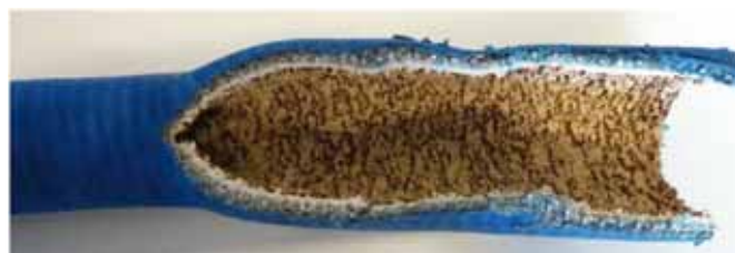
Figure 1: tuyau à lait après huit années d'utilisation
