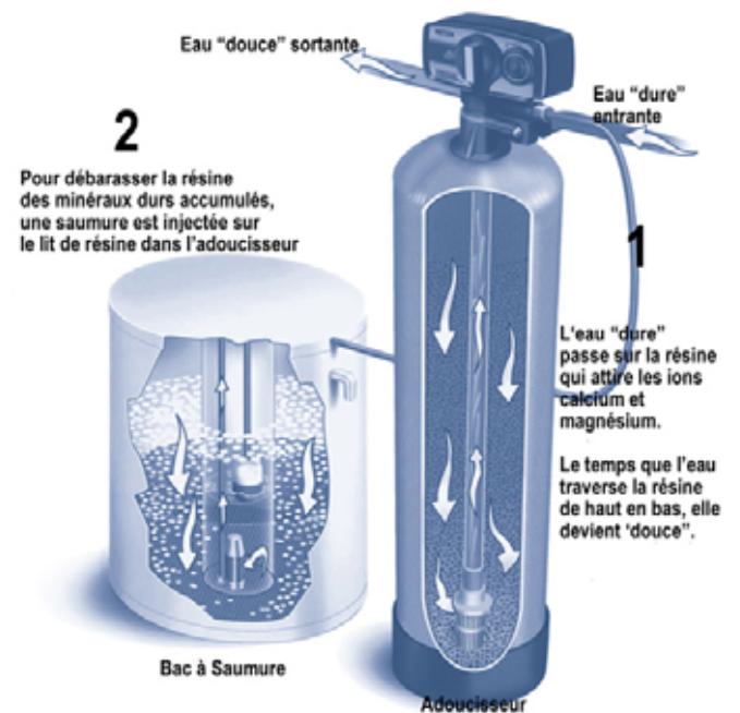
Figure 7: Fonctionnement d'un adoucisseur d'eau (source : www.maison-blog.ch)
