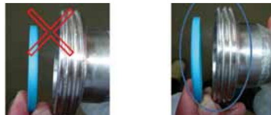
Figure 5: les joints types SMS prévu pour les gorges planes type SMS
