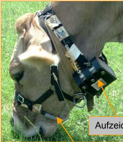
Flexibles Nasenband, versehen mit Sensoren
